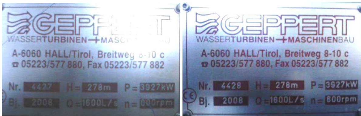
Figura 10 - Targhe delle 4 turbine Pelton.
